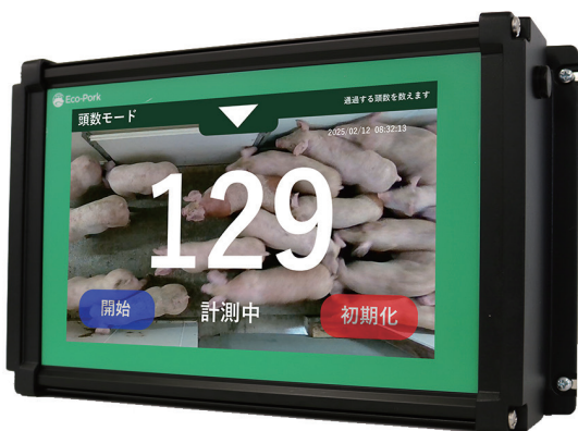
写真① 頭数モード画面。感圧式タッチパネルを採用。シンプルな画面設計で誰でも操作できる
