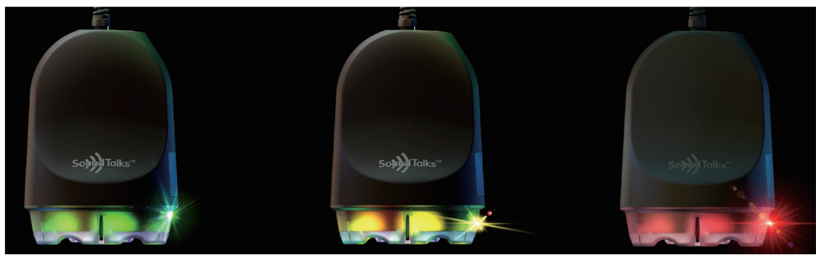
図1. 咳の状況に応じて3色に変化するモニター
